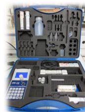
Photomètre pour les analyses rapides de l'eau
